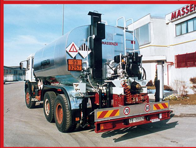
**Progettazione speciale** per bitumi ad alta viscosità, con circuiti a grandi passaggi liberi, riscaldamento oleotermico di tubazioni, valvole, barra, ecc.
